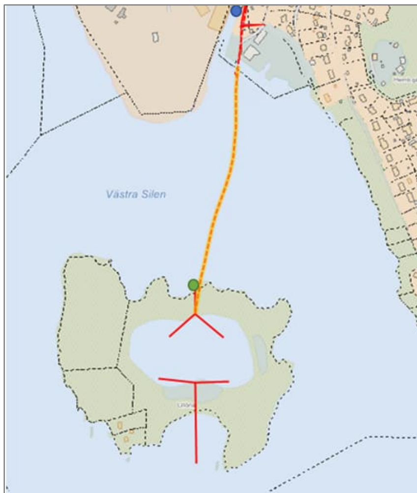
Figur 4. Kartbild som visar bräddpunkter vid huvudpumpstation och Lillöna. Vintertid då biodammen är frusen kan bräddning ske i brunn vid grön punkt. Vid högre vattenflöden, motsvarande 100-årsregn sker bräddning också i bräddavlopp vid huvudpumpstationen, utloppet är markerat med blå punkt. Karta: Årjängs kommun.
